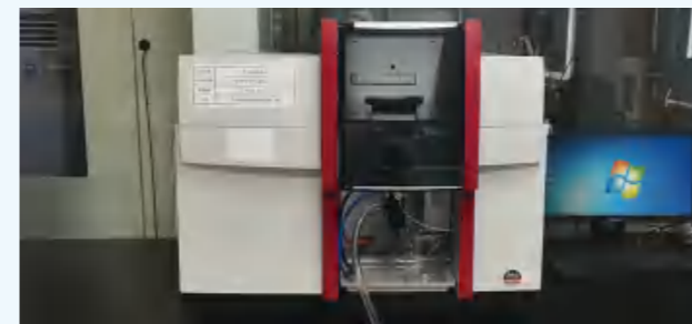
原子吸收光谱仪 Automatic absorption spectrometer (AAS)
